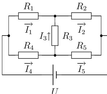
$$\begin{cases} R_1 \cdot I_1 + R_2 \cdot I_2 = U, \\ R_1 \cdot I_1 - R_3 \cdot I_3 - R_4 \cdot I_4 = 0, \\ R_3 \cdot I_3 + R_2 \cdot I_2 - R_5 \cdot I_5 = 0, \\ I_1 - I_2 + I_3 = 0, \\ -I_3 + I_4 - I_5 = 0. \end{cases}$$
